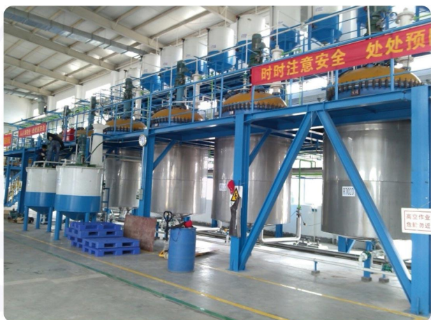
▲ 产品生产区域：生产基地（国科广化(南雄)新材料研究院有限公司）10吨级聚羧酸助剂生产线。目前基地拥有6条10吨、2条5吨的生产线。
